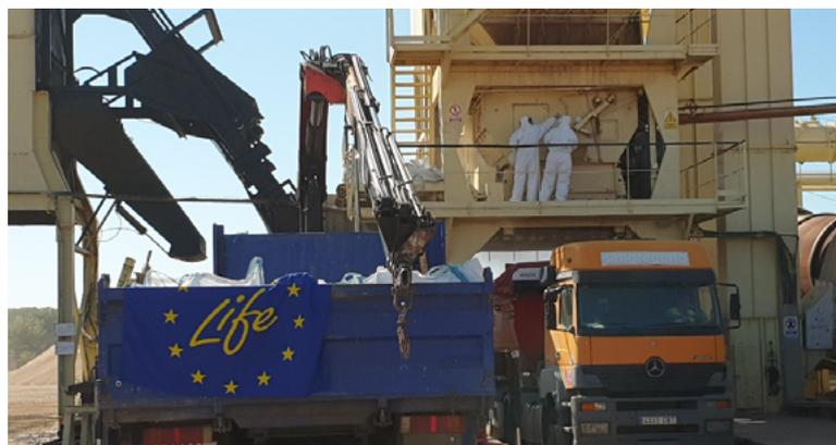
Foto 4. Introducción fibras de vidrio en el proceso de fabricación de aglomerado asfáltico.
