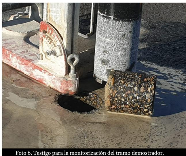
Foto 6. Testigo para la monitorización del tramo demostrador.
