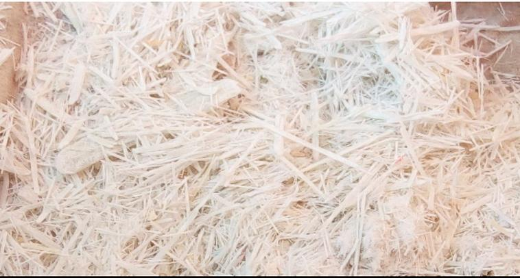
Foto 3. Proceso de reciclado mecánico de palas de aerogenerador. Obtención de fibras de vidrio de tamaño menor de 2 cm.
